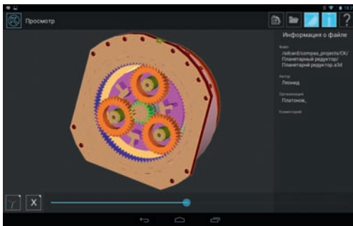
Динамическое сечение модели планетарного редуктора
