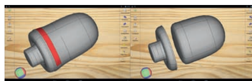
Разделение геометрической фигуры на две отдельные с помощью команды «Мост»
