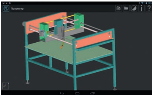
Сборочная модель наплавочного станка с ЧПУ, спроектированного в КОМПАС-3D
