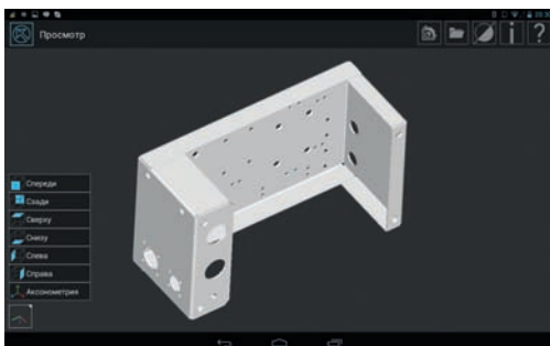
Пример отображения модели детали, изогнутой из листового алюминия, на планшетном ПК
