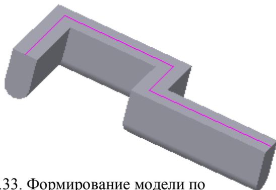
Рис. 5.33. Формирование модели по заданной траектории с использованием булевой операции **Пересечение элементов**
