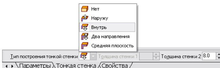
Рис. 5.29. Окно для задания параметров тонкой стенки
