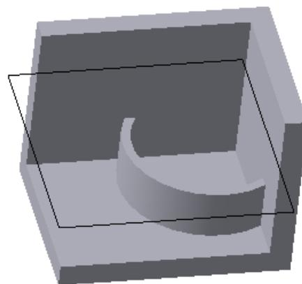
б) модель с выполненным ребром жесткости
