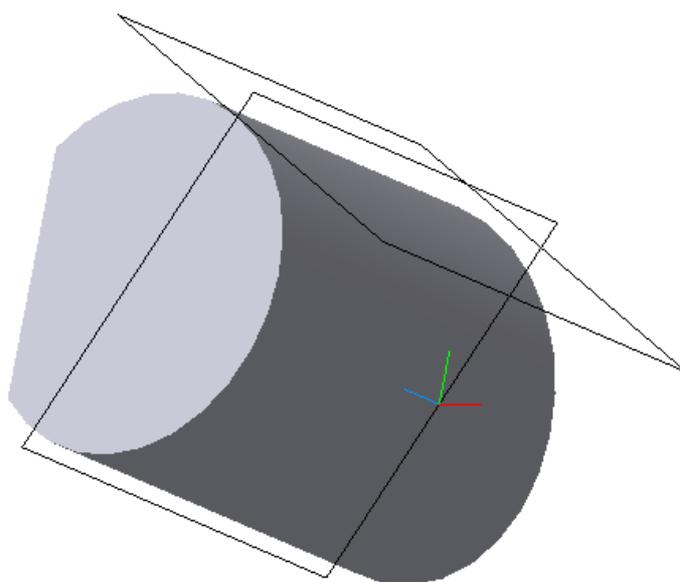
Рис. 6.12. Вспомогательная плоскость, касающаяся цилиндрической поверхности вращения
