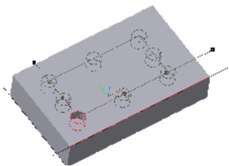
Рис. 7.14. Фантом массива отверстий в прямоугольной сетке
