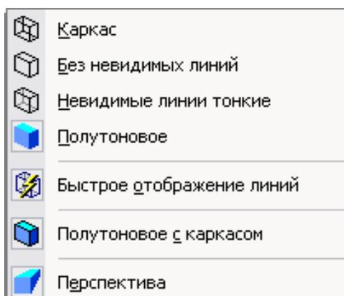
Рис. 5.4. Способы отображения
