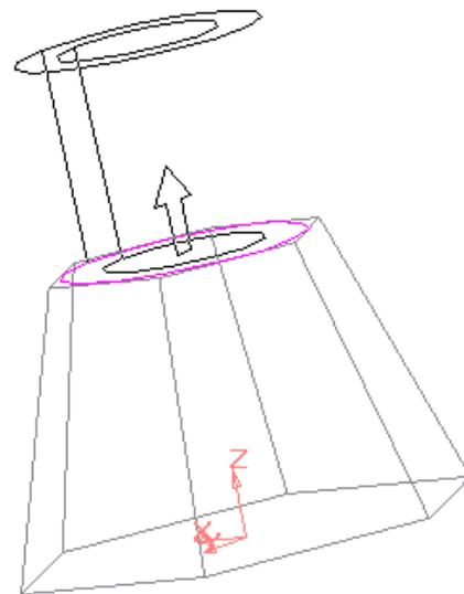
Рис. 5.23. Фантом элемента модели при приклеивании выдавливанием
