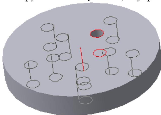
Рис. 7.19. Фантом массива отверстий по концентрической сетке
