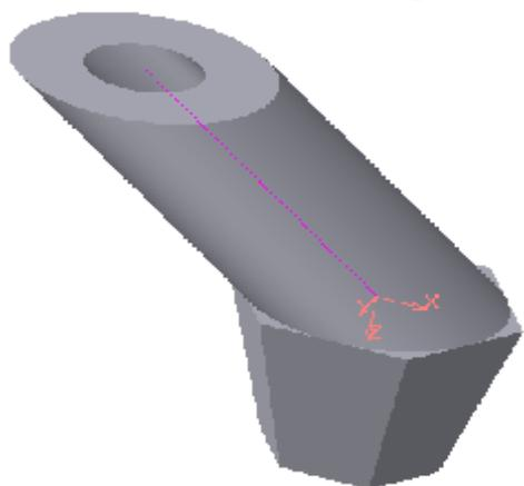
Рис. 5.28. Модель детали с приклеенным тонкостенным цилиндром
