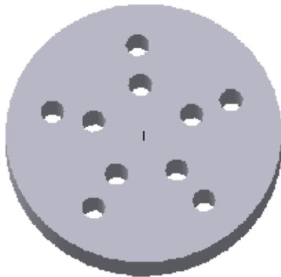
Рис. 7.21. Модель тела с выполненным массивом отверстий по concentрической сетке
