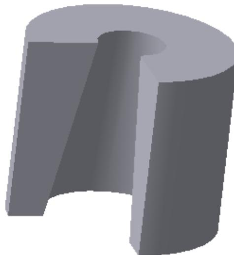
Рис. 7.12. Результат отсечения части модели по эскизу
