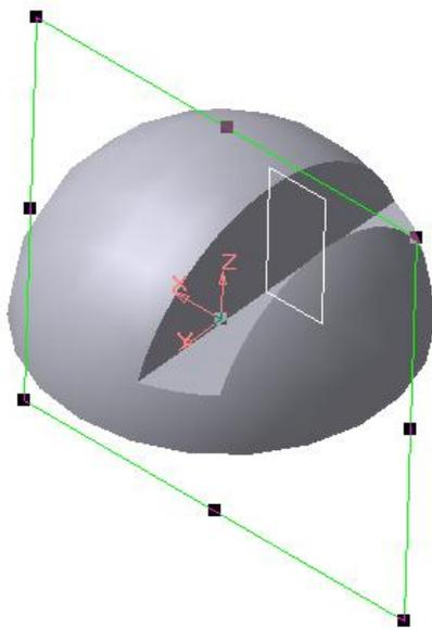
Рис. 5.30. Модель половины шара со сквозным вырезом
