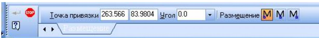
Рис. 3.16. **Панель свойств** для указания размещения надписи на чертеже (рис. 3.16). Указав графическим курсором на рабочем поле положение начальной точки текста, фиксируем его нажатием левой клавиши мыши.
