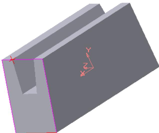
Рис. 6.7. Вспомогательная плоскость через ребро и вершину
