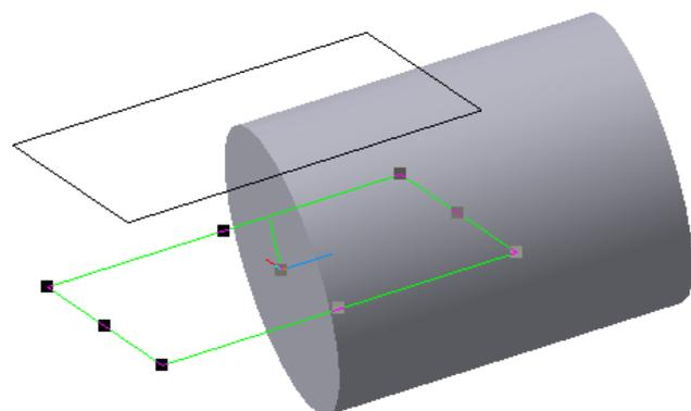
Рис. 6.5. Вспомогательная плоскость, смещенная относительно координатной плоскости **XOZ**
