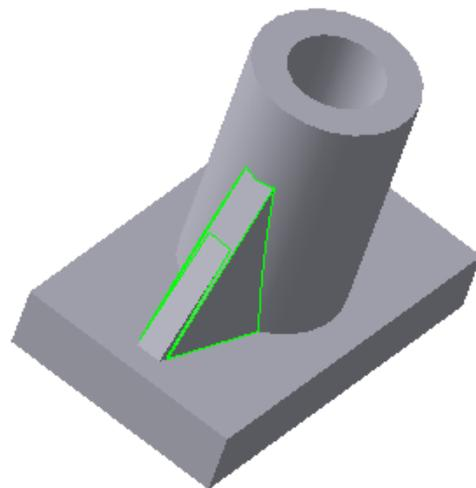
Рис. 7.8. Модель с ребром жесткости, выполненным с уклоном
