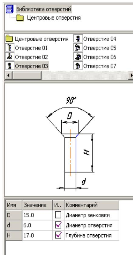
Рис. 7.4. Панель **Выбора** отверстий и их параметров
