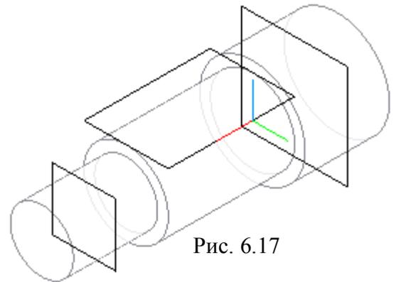
**плоскость** (рис. 6.17). Смещенные плоскости должны быть параллельны координатной плоскости **XZ**.
