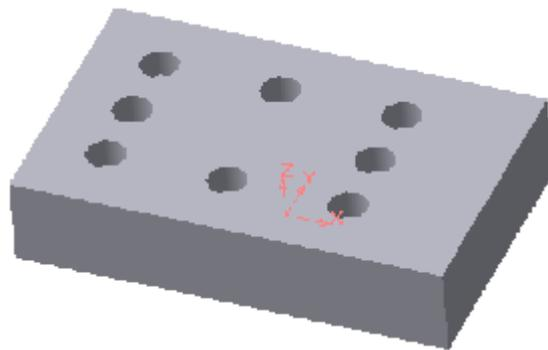
Рис. 7.18. Модель тела после создания массива отверстий
