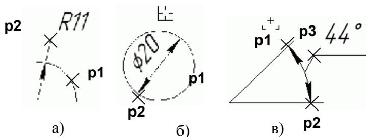
Рис. 2.10. Нанесение размеров дуги, диаметра окружности и углового размера
