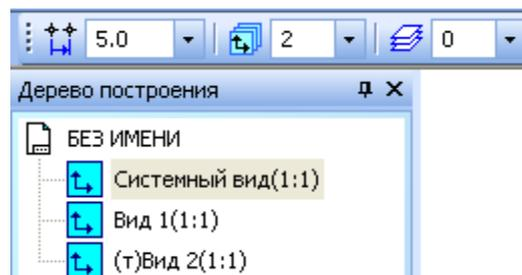
Рис. 3.8. **Дерево построения** при использовании нескольких видов детали
