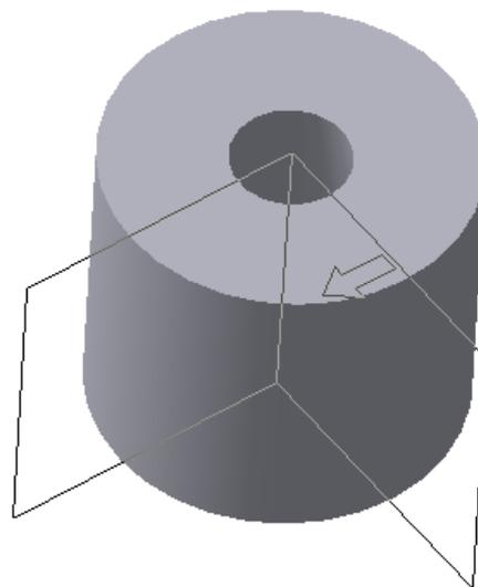
Рис. 7.11. Модель тела и проецирующей поверхности, заданной эскизом
