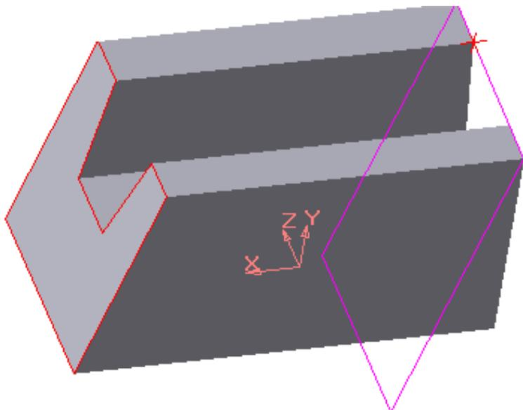
Рис. 6.9. Вспомогательная плоскость через вершину параллельно боковой грани
