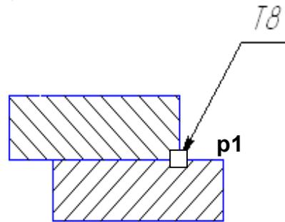
Рис. 3.19. Выполнение обозначения с использованием кнопки **Линии выноски**
