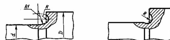
Переходной участок с разгрузкой канавки
