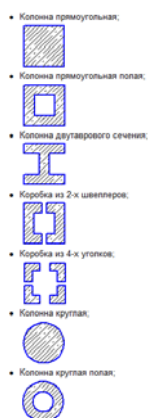
Рисунок 1.4.2. Возможные варианты выбора вида колонны.
