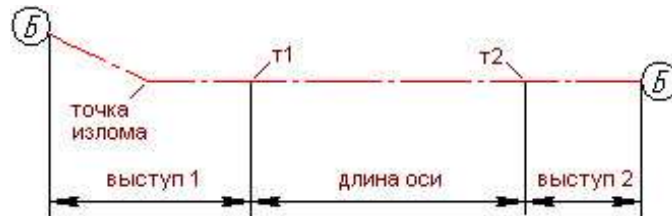
Рисунок 1.1.10. Характерные точки и основные параметры прямой координационной оси
