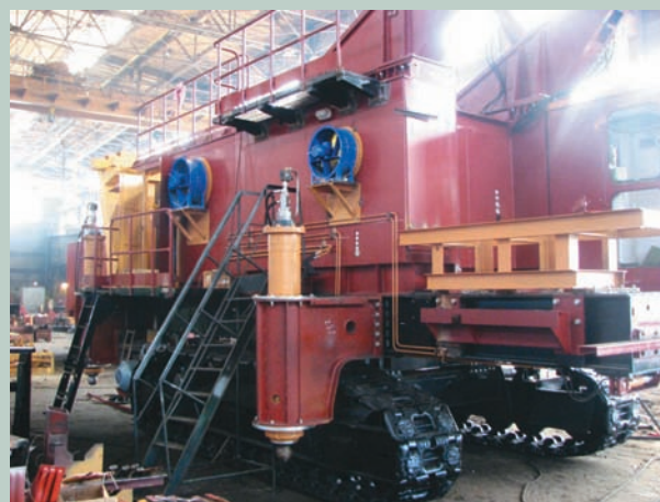
Сборка бурового станка в цехе предприятия
