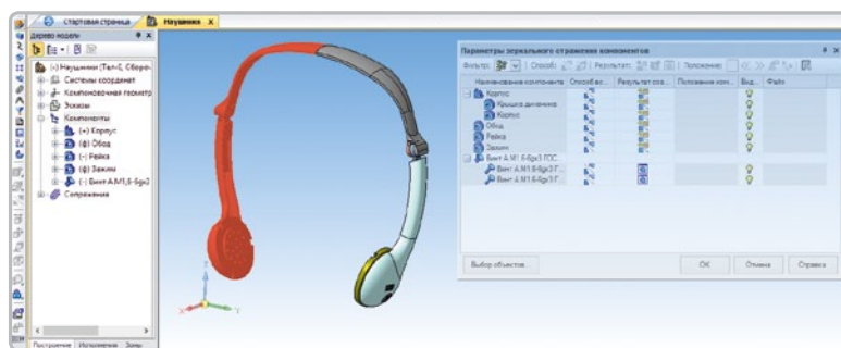
Рис. 9. Пример использования функционала зеркального отражения компонентов
