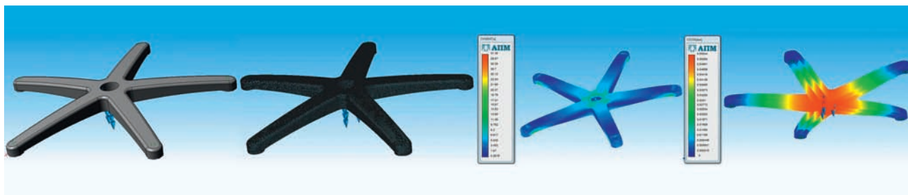
Рис. 4. Результаты расчёта на прочность крестовины офисного кресла
