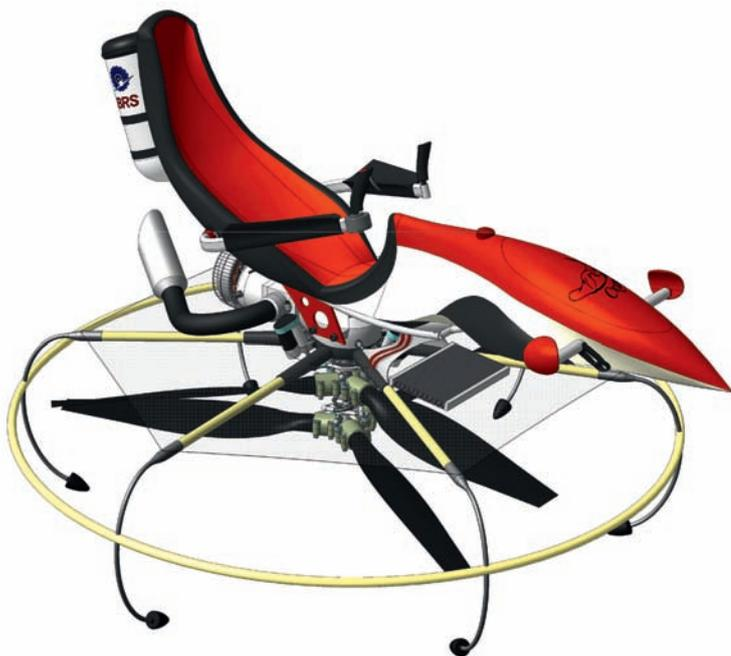
Катер представляет собой кресло пилота с обтекателем, установленным на моторно-редукторной части. Кресло с обтекателем выполняется одной деталью из стеклопластика. В кресле находится полость для трех литров масла, которое поступает в двигатель, смазывает его части и сгорает, как в двухтактном двигателе. В обтекателе расположен топливный бак, а в носовой части — управляющая электроника.
