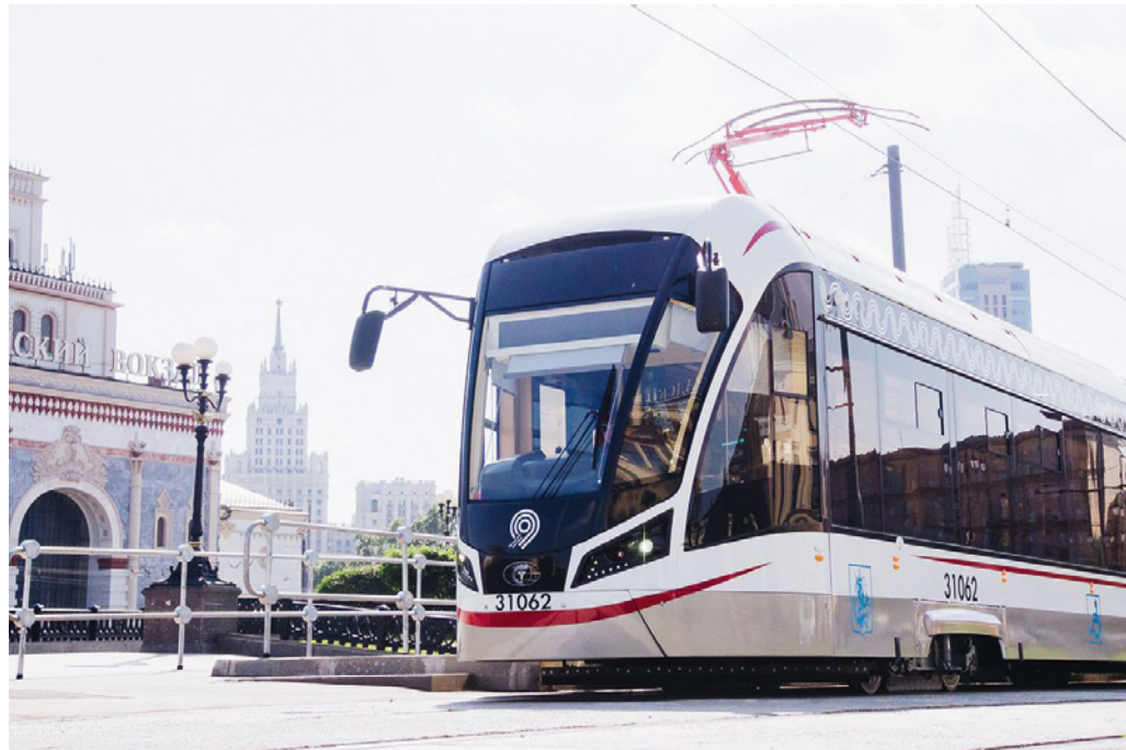
Беспилотный трамвай, спроектированный в КОМПАС-3D. Источник: ПК Транспортные системы
