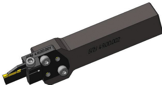
Модель сборки резца в КОМПАС-3D
