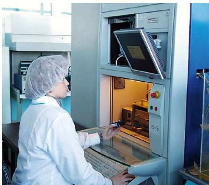
Измерение динамических параметров IGBT-модулей
