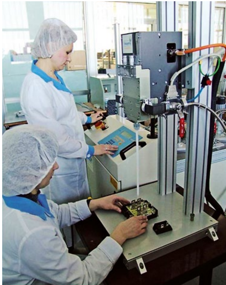
Дозированная заливка IGBT-модулей защитными компаундами
