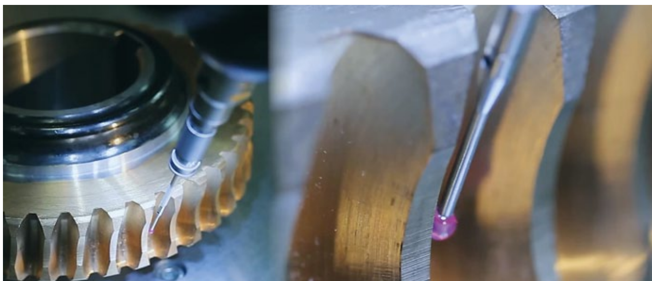
Измерение червячных зубчатых колес на КИМ
