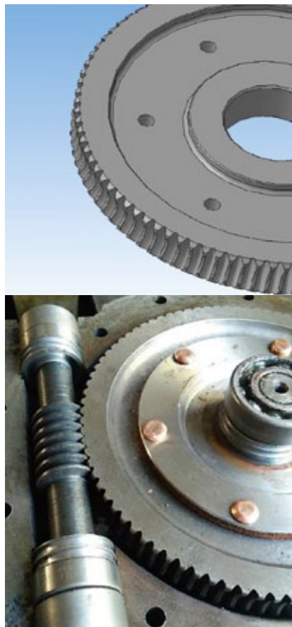
Результат изготовления червячного колеса по модели, построенной усилиями приложения Вали и механические передачи 3D
